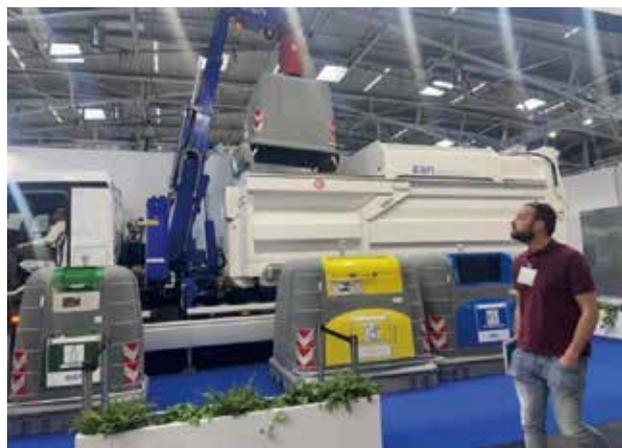
圖四、電動吸盤作業垃圾收集車（作者提供）
