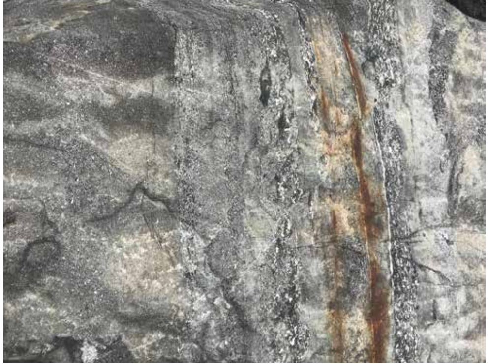
圖四、宜蘭縣東澳源頭山花岡片麻岩落石，其中密佈著多個方向的小斷層與裂縫。
