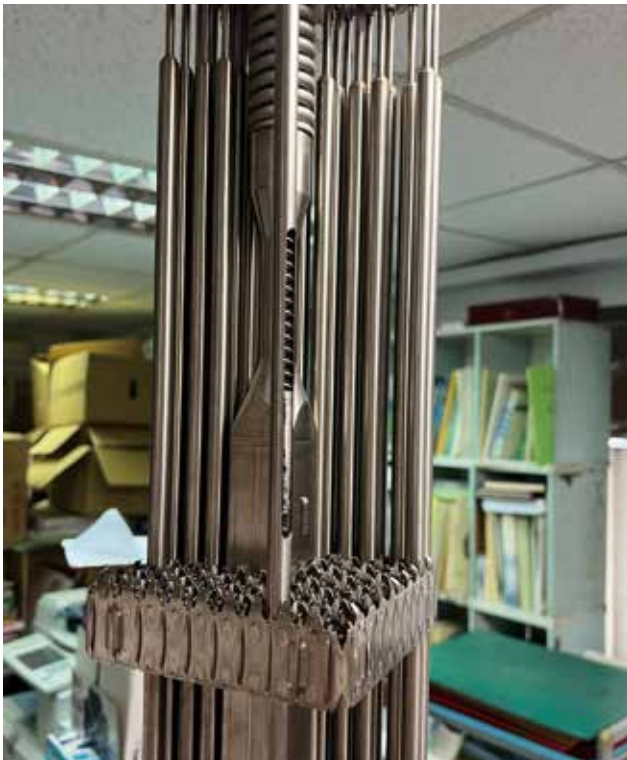
圖四、這個是核一跟核二沸水式的燃料的模型近照，用鈳合金的燃料護套，裡面就是燃料，有看到那個一顆一顆的，就是燃料丸。
