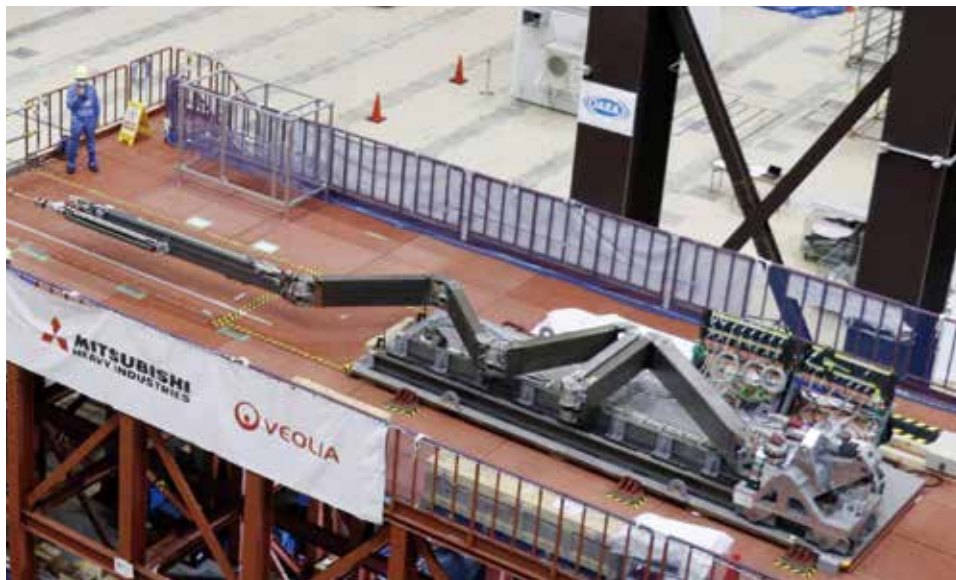
圖九、日本政府與東京電力公司為了要移除電廠核災之核燃料碎片，設計並建造了一個長約 22 公尺的機械手臂。（圖片來源：japantimes.co.jp）。
