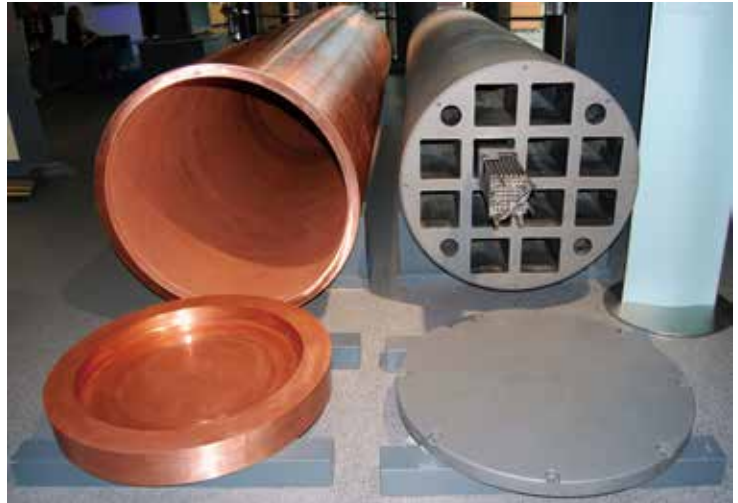
圖二、瑞士 SKB 公司設計的 KBS-3 Canister https://en.wikipedia.org/wiki/KBS-3
