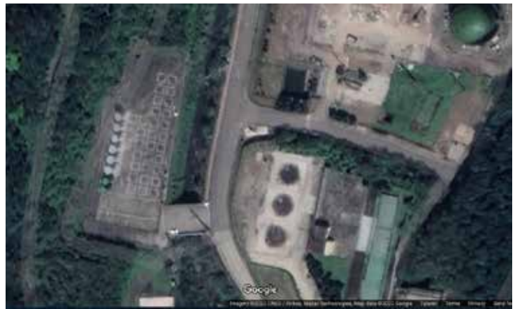
圖六、核一廠的乾式貯存場要經過乾華橋，橋面到溪底的高度有22.69公尺。且由此衛星空照圖也可以看出乾式貯存設施是沒有保持橫向搬移的適當操作間距。圖片來源：Google Map
