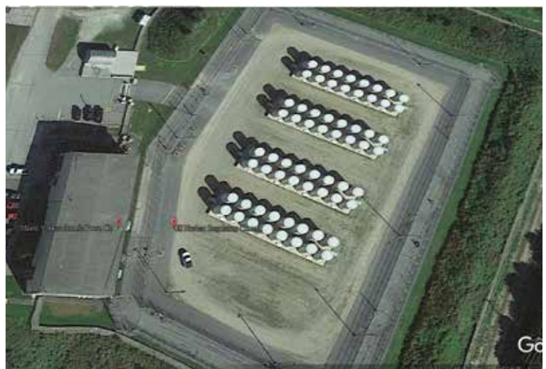
圖七、由美國緬因·洋基(Main Yankee)核電廠衛星空照圖，可見其乾式貯存擺設位置均保有橫向搬移的間距。圖片來源：Google Map
