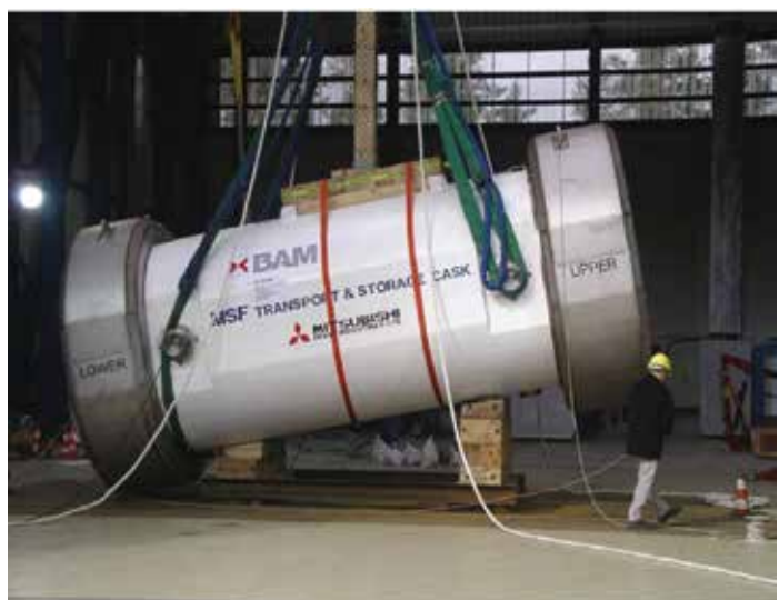
圖四、三菱重工在德國進行的核廢燃料棒運輸箱的墜落測試。圖片來源：National Academies Press
