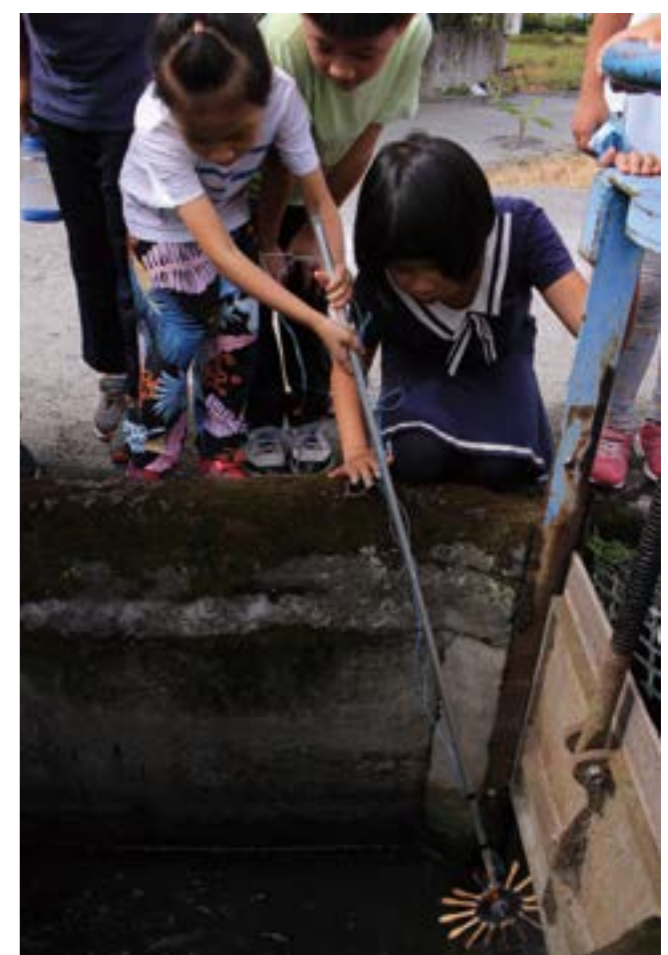
圖二、參加綠能科學營的學童親自將小水力轉動棒放在水道中，測試不同位置、高低落差、放置高度的水流速度如何影響轉速。
