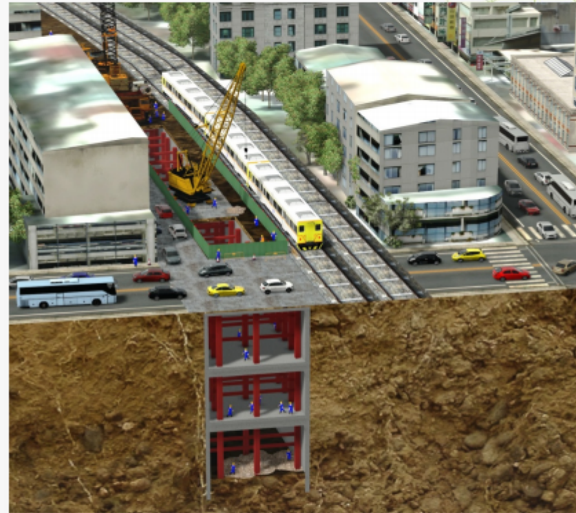
核定版明挖覆蓋施工模擬圖
