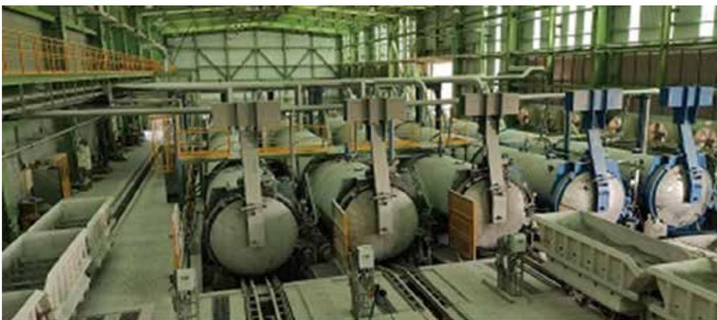
圖八、為高溫蒸汽釜的實景照片（作者提供）
